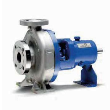
Bomba horizontal de voluta partida radialmente, diseño “back pull-out”, con impulsor radial, de aspiración simple, monoetapa, según ISO 2858 / ISO 5199
