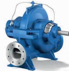
Bomba de voluta partida axialmente, monoetapa, para instalación horizontal o vertical, con impulsor radial de doble aspiración, bridas de conexión según DIN, EN o ASME
