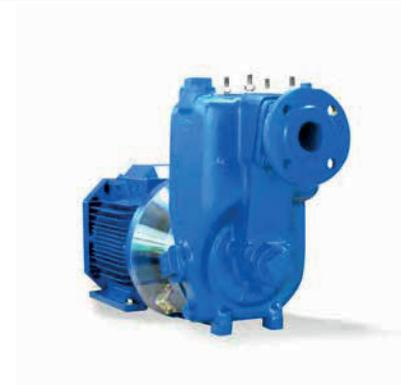
Bomba centrífuga autoaspirante horizontal de tipo monobloc, impulsor abierto o semiabierto, con ajuste mediante placa de desgaste, con cierre mecánico, accionamiento mediante motores eléctricos
