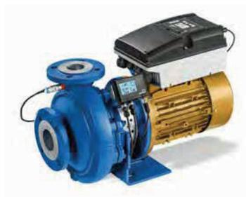
Bomba monobloc de voluta, monoetapa, con rendimiento según EN 733, casquillo del eje y anillos de desgaste recambiables y sistema de regulación de velocidad integrado sobre el motor
